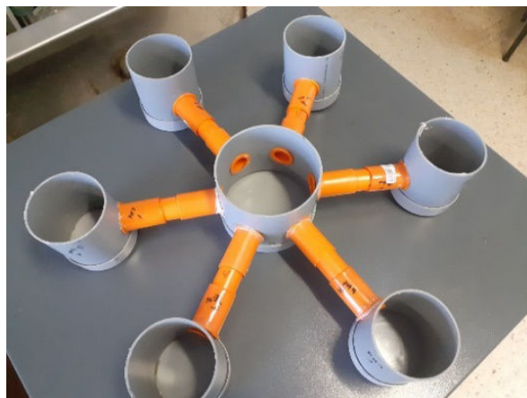
Figura 1. Olfatómetro de seis brazos construido con tubos de PVC de diferentes diámetros en la Facultad de Ciencias Agronómicas, Universidad de Chile, utilizando las especificaciones dadas por Rasmann et al. (7) y con autorización de esos autores. 1 / Custom-made six-arm olfactometer with PVC pipes of different diameters made at the Faculty of Agronomic Sciences, University of Chile, using the specifications given by Rasmann et al. (7) and with the authorization of those authors. 1
